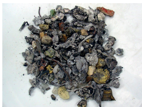
Abbildung 1: Metallstücke, die aus KVA-Schlacke zurückgewonnen wurden.
